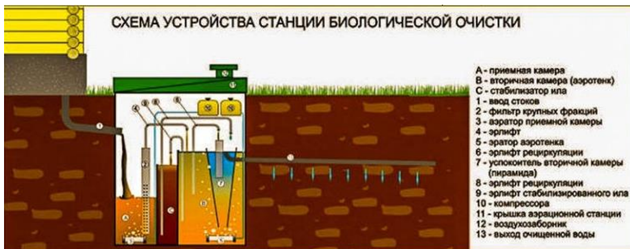
Рис.14. Станция биологической очистки.
