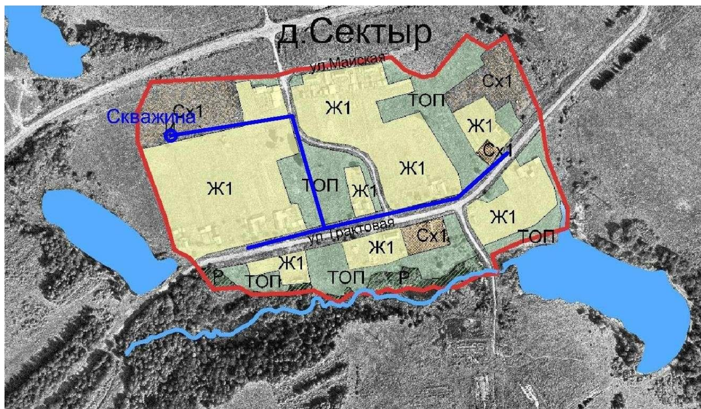
Рисунок 6. Схема водопроводной сети деревни Сектыр
