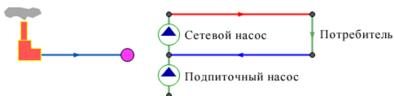
Рисунок 3.4 - Слева однолинейное изображение сети, справа – внутреннее представление.
